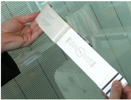
Une puce RFID développée par IER est intégrée aux étiquettes Air France. Journal du Net / Agathe Azzis
